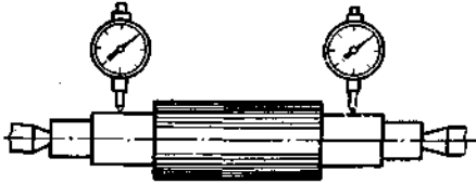
Рис. 17.1. Контроль несоосности шеек вала
